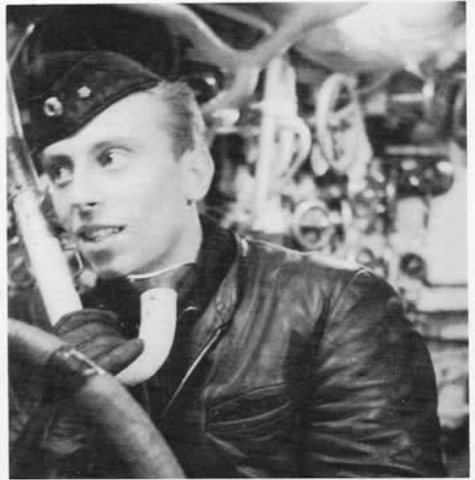
Der Seitenrudergänger in der Zentrale von HAI mit dem Sprachrohr zur Brücke und zum Turm. Dort waren keine weiteren Seitenruderstände mehr vorhanden.
