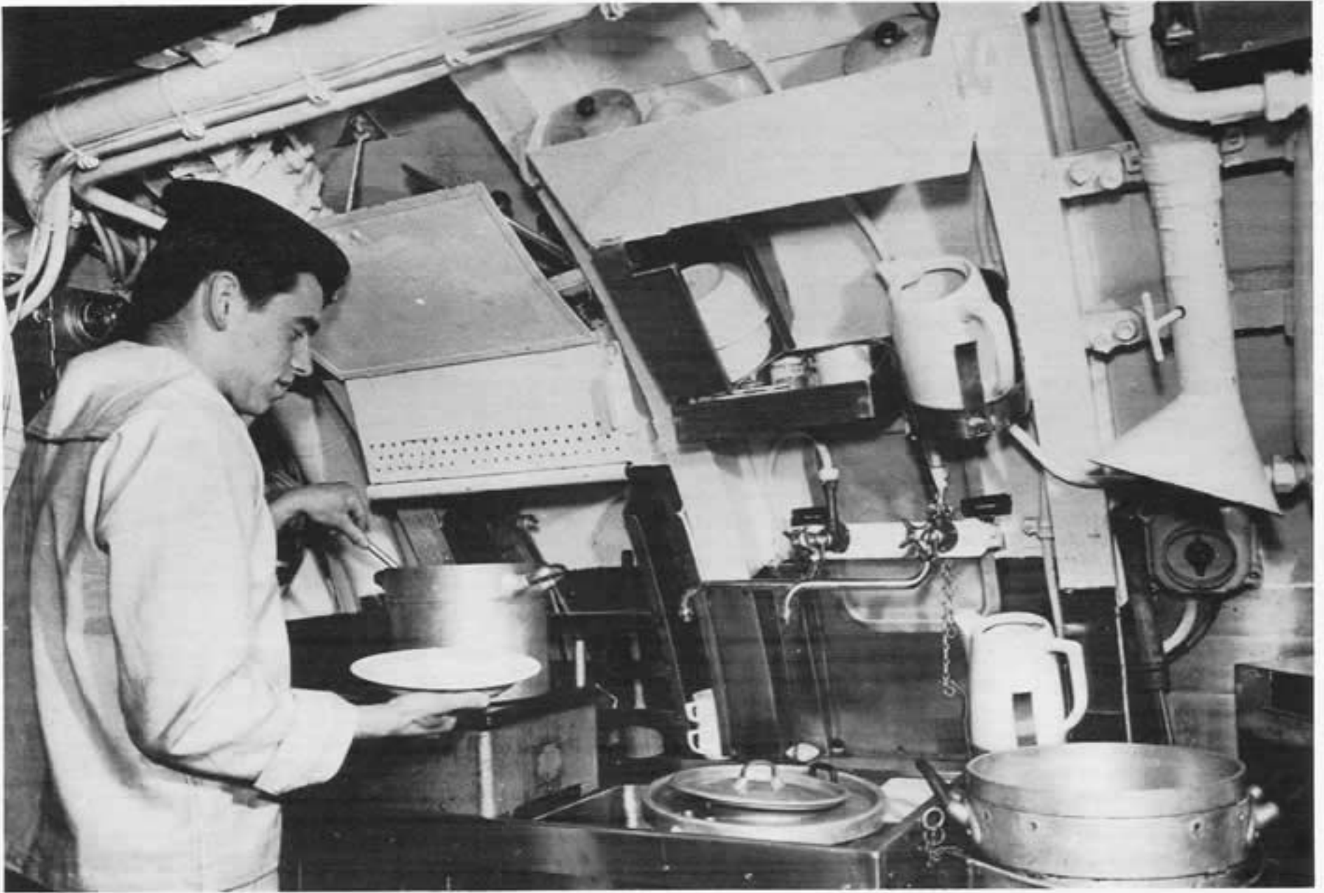
Zwei Aufnahmen von der Kombüse an der Bb-Seite des Bugraumes. An der Schottwand zur Zentrale ist die Handtrinkwasserpumpe angebracht, dann folgt ein kleiner Elektroherd mit zwei Kochplatten von je 1,2 kW, ein Abwaschbottich mit den Hähnen für See- und Trinkwasser und davor ein elektrisch heizbarer 20-l-Kochkessel von 2,5 kW. Damit mußte der Smutje für die 14-17 Mann Besatzung das Essen bereiten.
