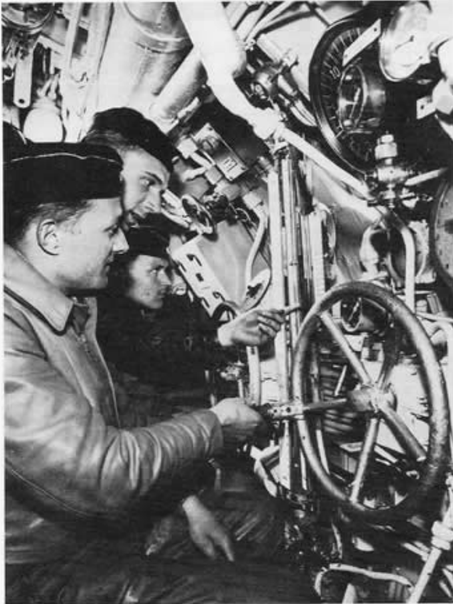
STO-Ausbildung am Tiefenruderstand von HECHT. Am vorderen Tiefenruder sitzt OL Görg, am hinteren OL Ebert. Der Ausbilder, OL v. Hering, zeigt auf das Papenberg-Manometer für die genaue Tiefenablesung auf Schrohrtiefe.
