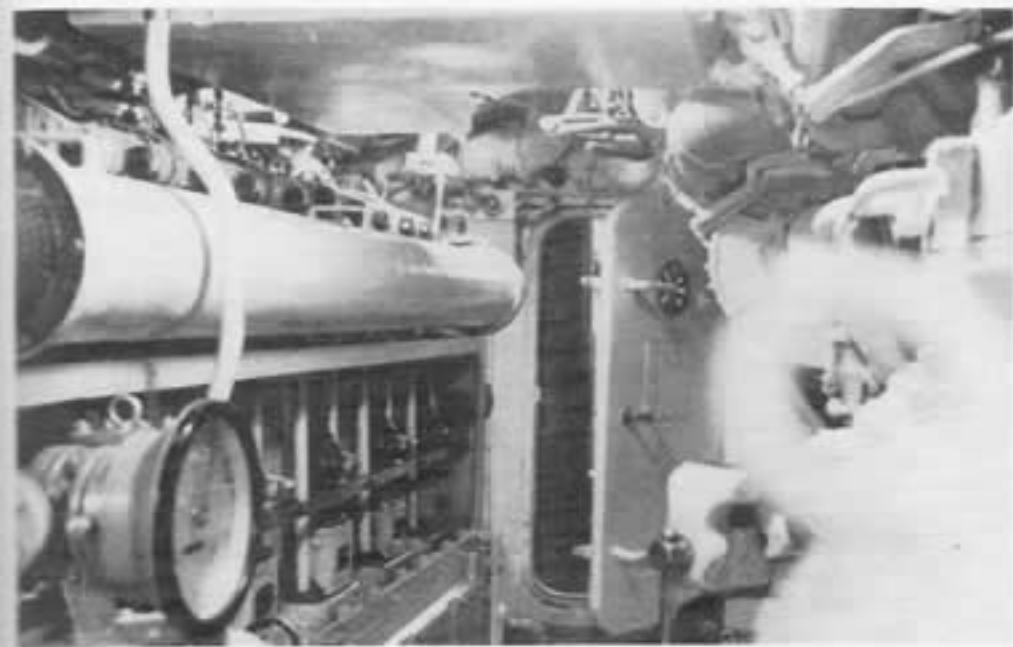
Auf der Stb-Längsseite des Dieselmotors liegen die Steuerwelle mit der Nocken- und Ventilbetätigung, die Treiböleinspritzpumpen und das Zuluftrohr. Die Bedienung erfolgte von der vorderen Stirnseite. Hinter dem Dieselmotor war die Hauptkupplung angeordnet.
