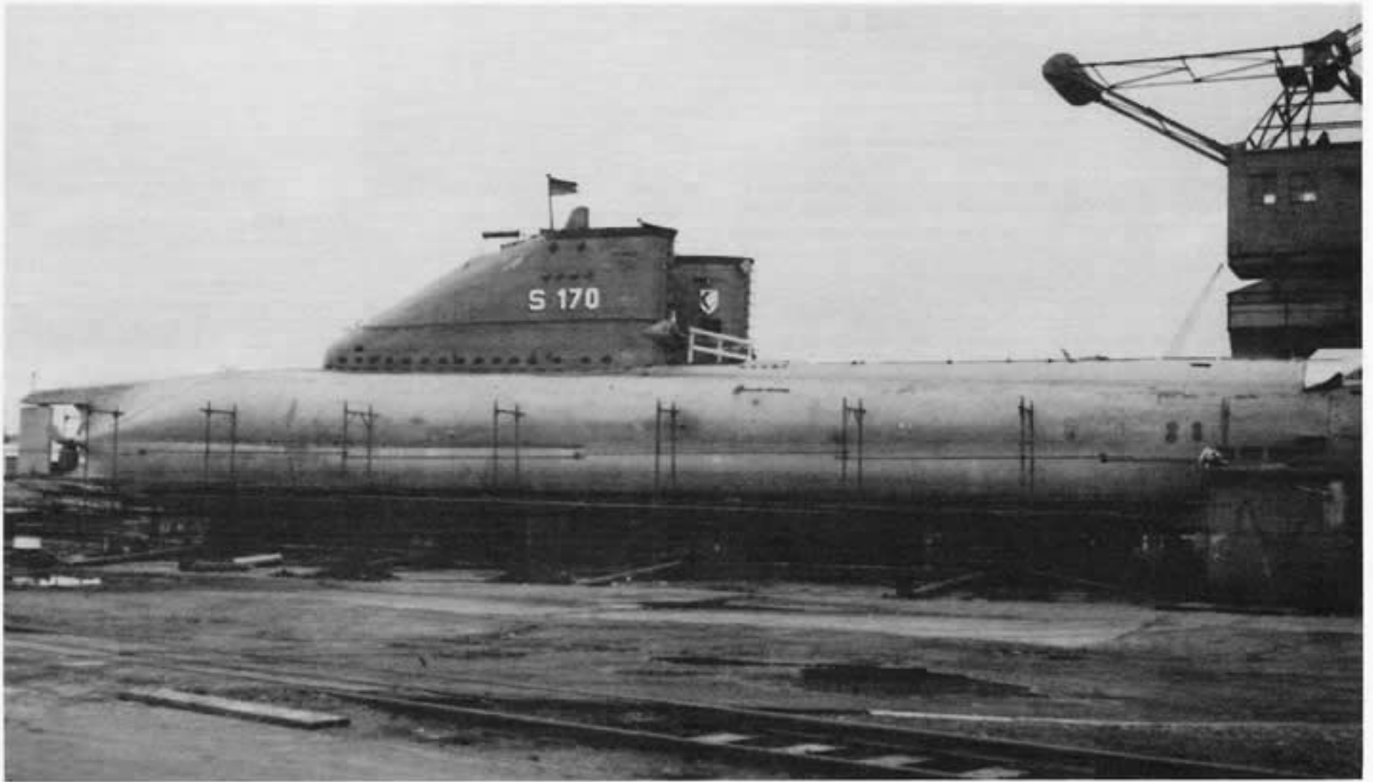
HAI und HECHT im Frühjahr 1961 bei einer Werftliegezeit auf dem Gelände der Werft Blohm+Voss in Hamburg. Hierbei erhielten beide Uboote eine strömungsgünstigere Turmverkleidung, die den Schalldämpfer miteinbezog.
