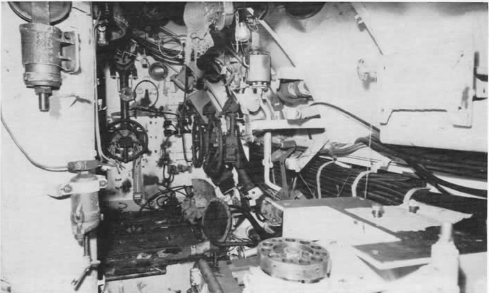
Die gleiche Ansicht wie beim Bild linke Seite unten nach dem Wiedereinbau der Steuereinrichtungen für die Tiefen- und das Seitenruder. Es fehlen noch die Anzeigergeräte und die Ventile der Hd- und Nd-Luftanlagen.
