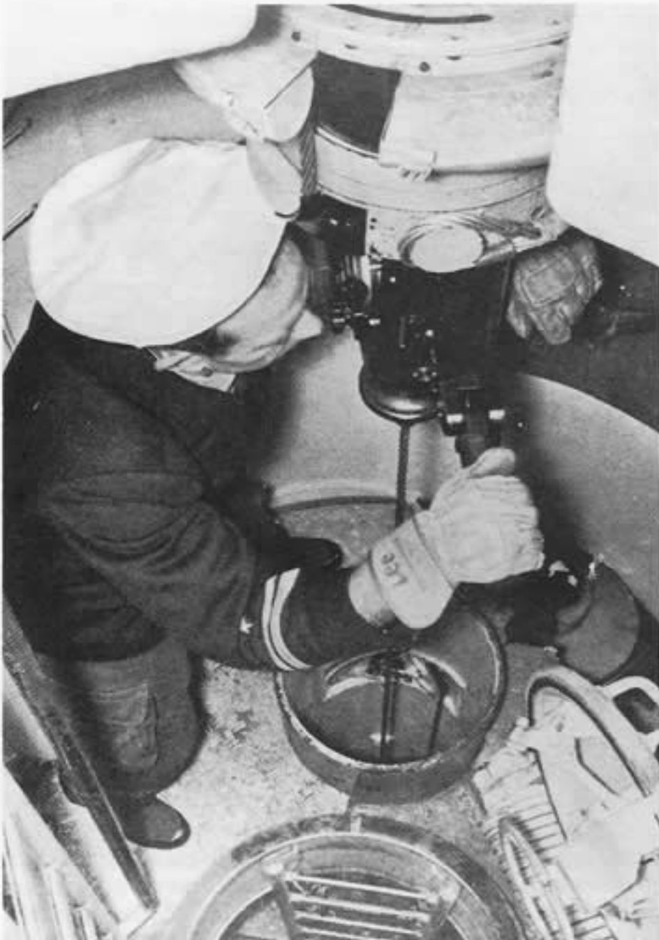
Der Kommandant im Turm am Sehrohr. Der Typ XXIII besaß ein 7,50 m langes Angriffsschrohr mit 4,16 m Hublänge, das bei Tages- und Nachtangriffen verwendet werden konnte. Geringe Tiefenänderungen mußten durch entsprechende Körperhaltung ausgeglichen werden (Kniebeugeschrohr).
