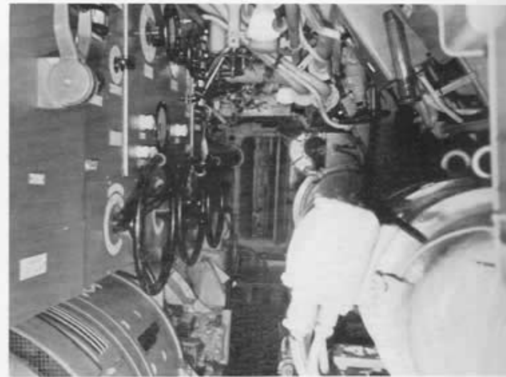
Die Hauptschalttafel mit dem Batterieselbstschalter, darunter der Haupt-E-Motor und gegenüber der Luftverdichter. Vor der Schalttafel ist ein Maschinentelegraph angeordnet.
