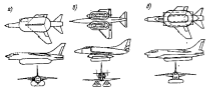
Рис. 77. Система шасси на воздушной подушке: а — с одной камерой под корпусом; б — с двумя камерами, помещаемыми под крыльями; в — с камерой, встроенной в фюзеляж.
