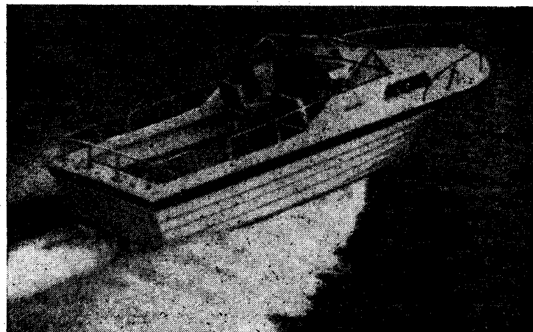
Рис. 87*. Открытый мореходный спортивный катер с небольшой каютой-убежищем (модель «Эвенжер»), построенный на верфи «Пенн Ян». Катер длиной 7 м может быть оборудован двигателем «Крайслер-V-8» мощностью 225 или 260 л. с.
