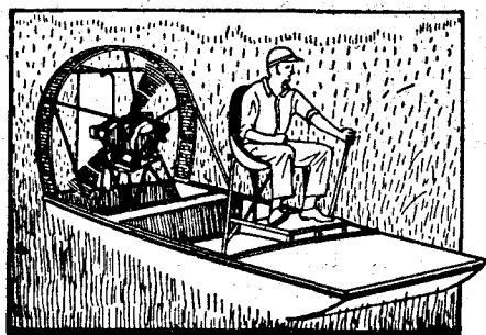
Рис. 198. Катер с воздушным винтом (аэробот). Пригоден для передвижения по обширным болотистым районам.
