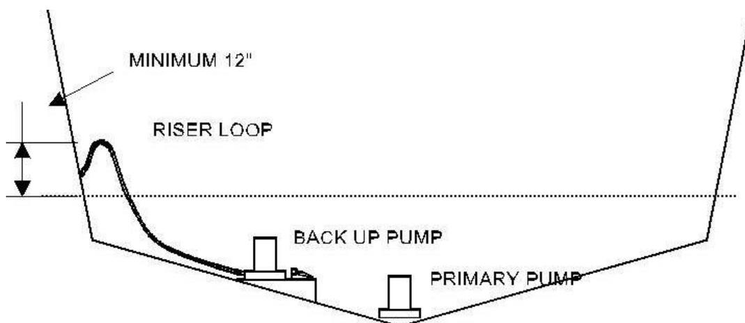
RECOMMENDED INSTALLATION ARRANGEMENT FOR BACK UP BILGE PUMP
